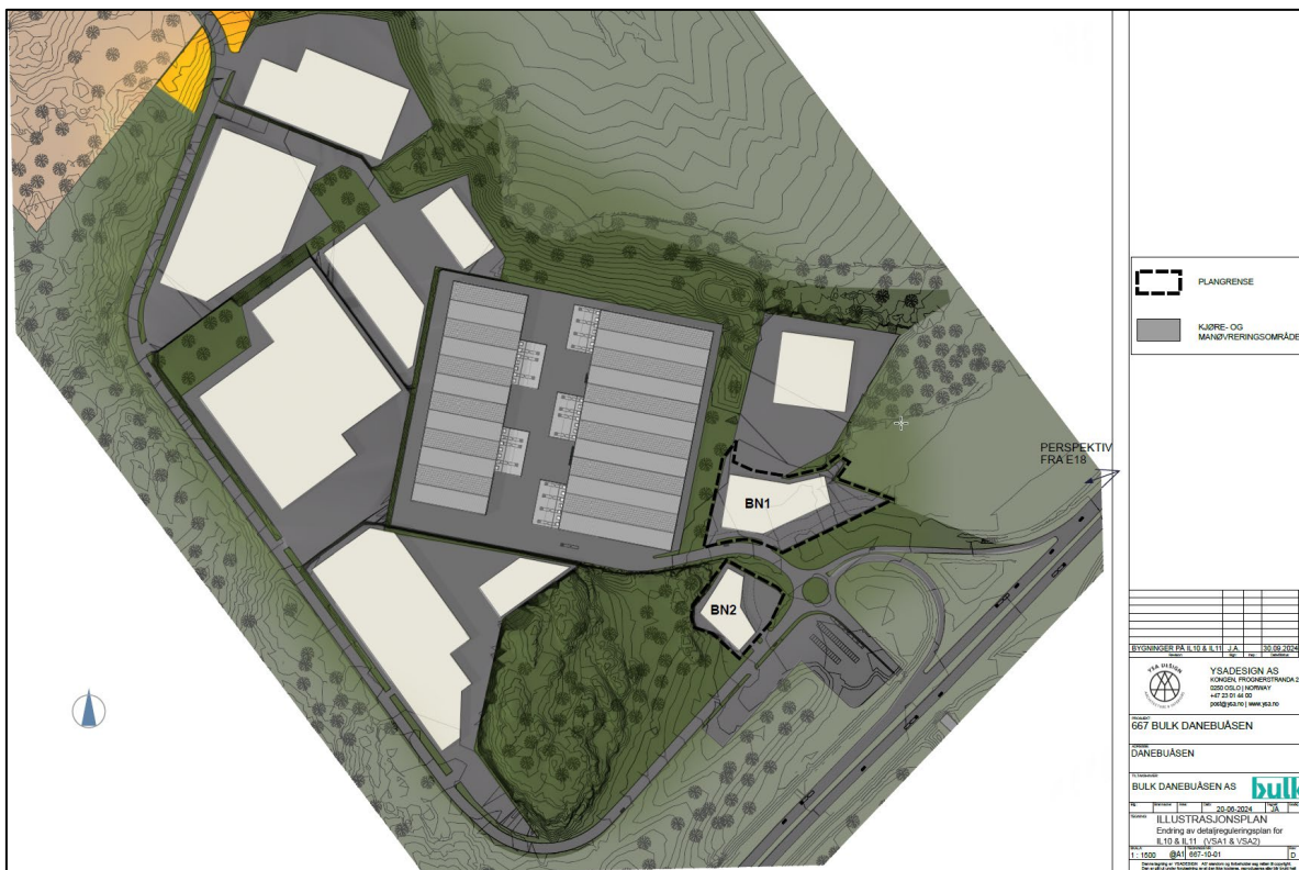
Figur 6-3: Illustrasjonsplan for tiltaket utarbeidet av YSA Design, datert 30.09.2024. Den stiplede avgrensingen viser området som foreslås endret i planen. Det er i illustrasjonsplanen lagt opp til en utnyttelse på 45 % BYA for felt BN1 og 50 % BYA for felt BN2.
