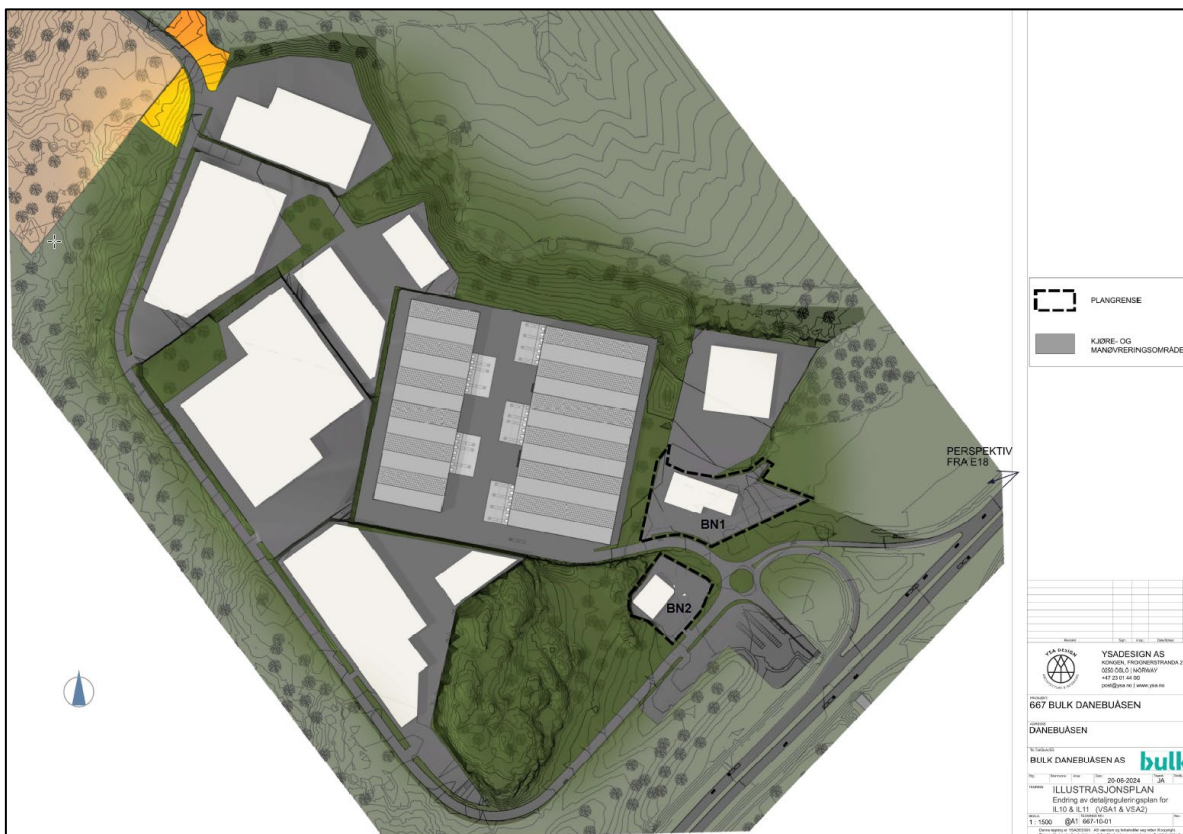
Figur 6-4: Illustrasjonsplan for tiltaket utarbeidet av YSA Design. Den stiplede avgrensingen viser området som foreslås endret i planen. Illustrasjonsplanen viser hvordan området vil se ut med en utnyttelse på 30 % BYA for felt BN1 og 30 % BYA for felt BN2.
