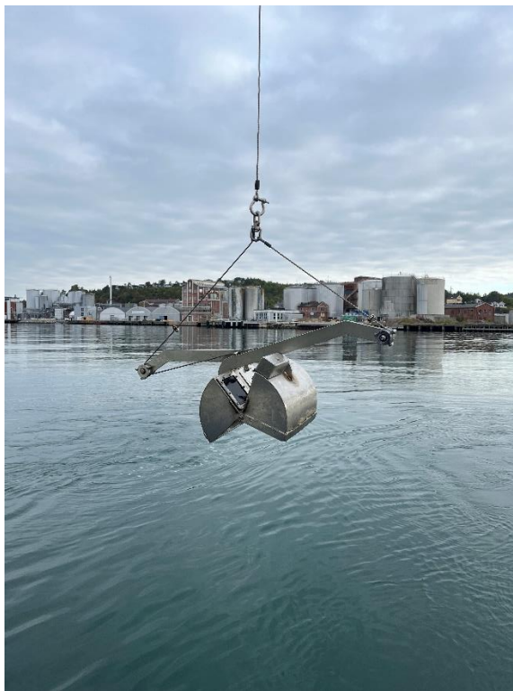
Figur 16. Prøveinnsamlingen i 2019 og 2022 ble gjennomført med en 0,1 m 2 Van Veen grabb (venstre). Hydrografiske data ble samlet inn med både en CTD av typen Seabird og en SAIV SD208 (høyre).
