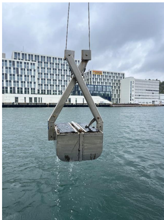
Figur 3. Gemini kjerneprøvetaker brukt for å hente inn sediment i Sandefjordsfjorden i 2019 og 2022 (bilde til venstre). I 2022 ble det på enkelte stasjoner benyttet en stor grabb (bilde til høyre) da det ikke var mulig å få opp sediment med Gemini-kjerneprøvetakeren.
