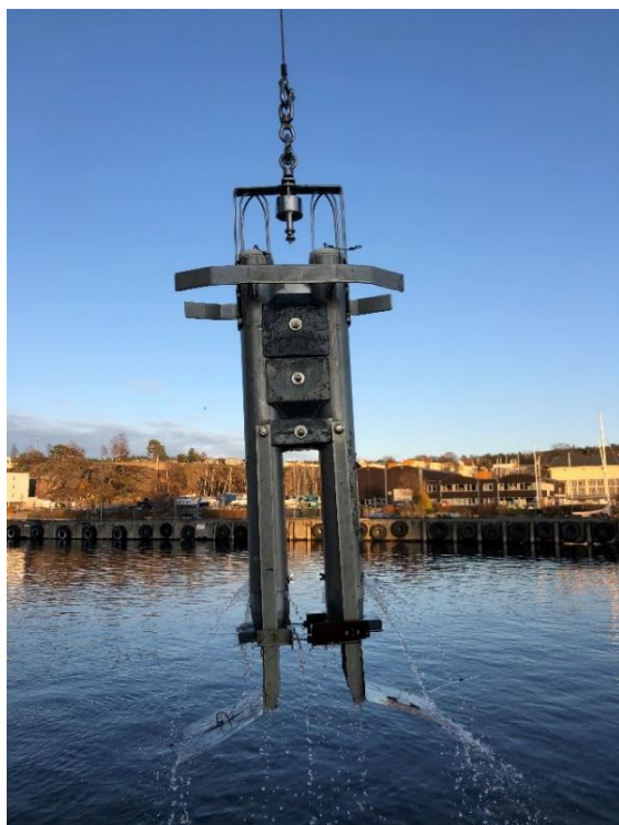
Figur 3. Gemini kjerneprøvetaker brukt for å hente inn sediment i Sandefjordsfjorden i 2019 og 2022 (bilde til venstre). I 2022 ble det på enkelte stasjoner benyttet en stor grabb (bilde til høyre) da det ikke var mulig å få opp sediment med Gemini-kjerneprøvetakeren.
