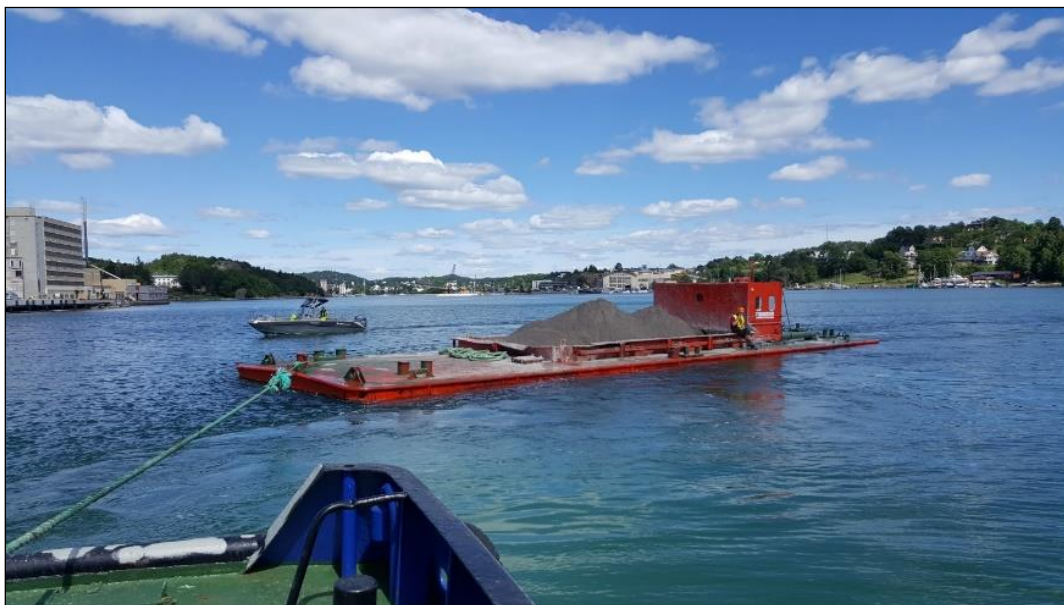
Figur 7. Fallbunnslekter fullastet med tildekkingsmasser (foto: Sandefjord kommune)
