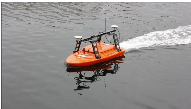
Figur 9. Måledrone for grunne områder under 2 meters dybde (foto: Skanska)
