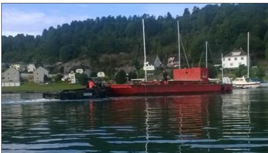
Figur 12. Utlegging med fallbunnslekter ved testfelt 5 (foto: Bjørn Nygård)
