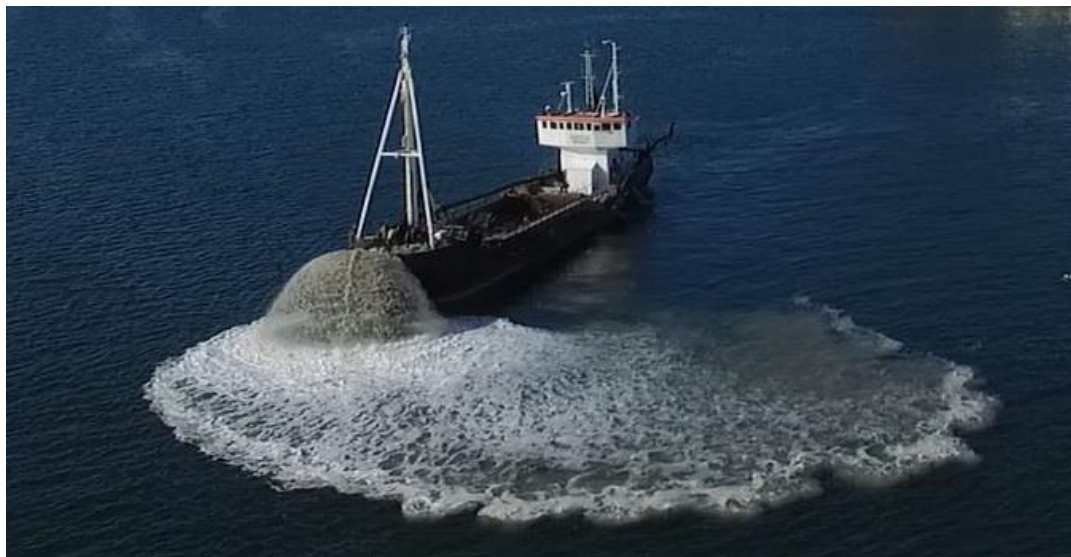
Figur 8. Skipet Arena utstyrt for utspyling av masser fra baugen (foto: Sandefjord kommune)
