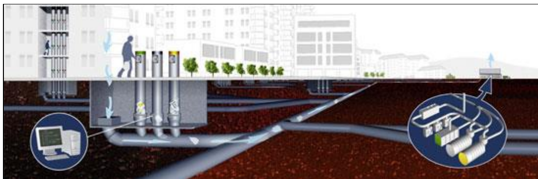
Figur 5-10 Stasjonært avfallssug. (Kilde: www.envac.no )
