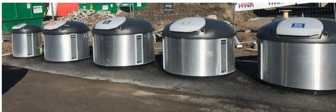
Figur 3-4: Delvis nedgravd containerløsning for 5 avfallstyper
