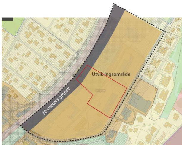
Figur 4 Følge jernbanelovens 30-metersgrense fra spormidt og vei- og kryssløsning over jernbane, utenfor planområdet.
