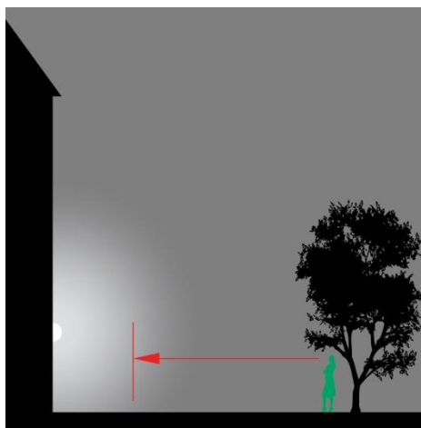
Vegghengte armaturer bør ikke blende, men være avskjernet som illustrasjonen til venstre.
